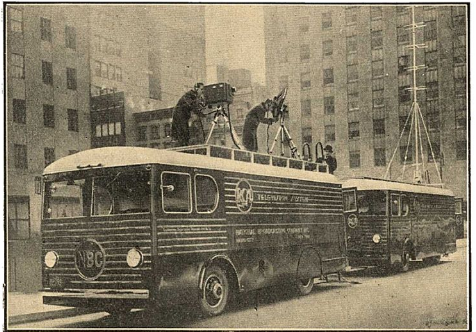
Fig. 3. — Reportage télévisé par la N.B.C. La première voiture comprend la prise de vue et de son, les étages B.F. et Vidéo. La deuxième, l'émetteur H.F. et l'antenne.
