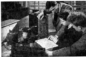
Etude des figures de Lissajous. L'oscillographe utilisé est de fabrication américaine (A.B. DU MONT). On remarque à gauche un Alter-nostat FERRIS.
