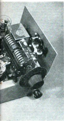
La plaque L 1 et L 2 avec l'enroulement antenne L 3 . de l'ensemble en les comparant à celle des lampes.
