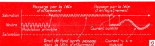
FIG. 2. — Action d'une tête d'effacement alimentée par courant continu, et d'une tête d'enregistrement alimentée par un courant continu superposé au courant musical. Le bruit de fond est affaibli.
