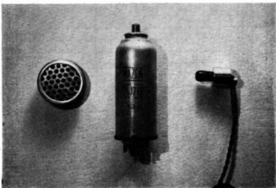
Microphone et contour miniatures comparés à une 6Z5 Mazda.
