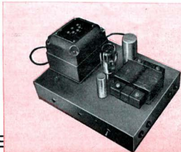
Montage de la partie alimentation sur châssis séparé.
