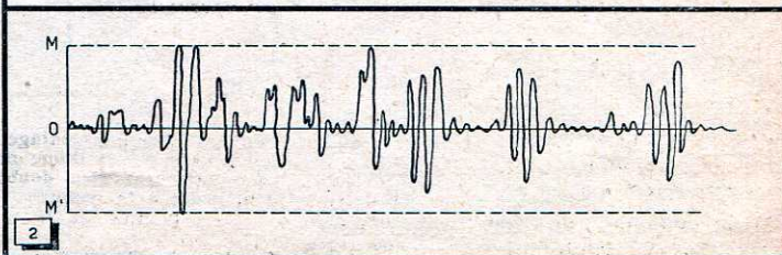
Fig. 2. — Aspect général d'un oscillogramme relevé sur la parole.
