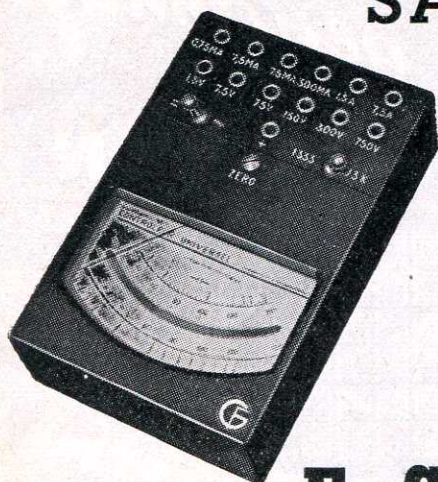
CONTROLEUR 13 K Capacités - Résistances 13.000 ohms par Volt. avec adaptateur CR
