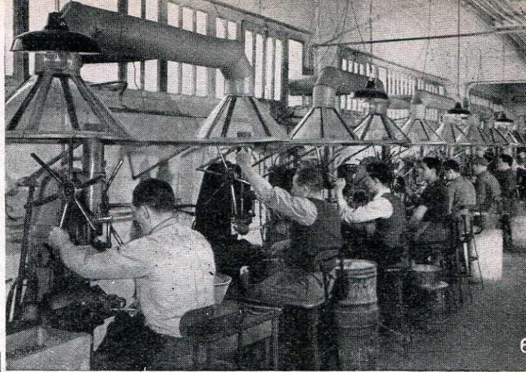
Fig. 6. — Atelier des circuits magnétiques : presses à injection sous pression.
