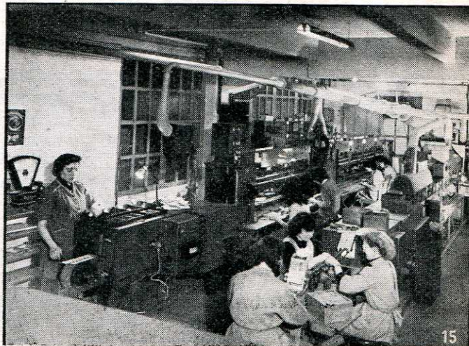
Fig. 15. — Atelier de fabrication des condensateurs au mica argenté : la machine de gauche effectue les opérations de dépôt et de fixation de l'argent, celle de droite le triage et l'enrobage automatique.
