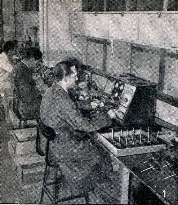
Fig. 1. — Contrôle électrique des blocs en fin de chaîne.
