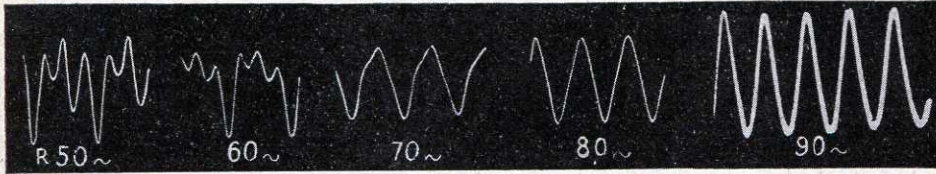
Fig. 14. — Pavillon exponentiel de 1,05 m de long (bouche de 60 cm de côté). L'intensité sonore est élevée, mais la forme ondulatoire est médiocre à 50 et 60 Hz.
