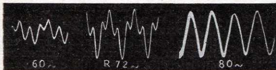
Fig. 3. — Formes ondulatoires restituées par le haut-parleur de 20 cm de diamètre monté sur petit baffle plan (75 × 90 cm) placé en encoignure à l'intérieur du laboratoire. Remarquer l'importance de la distorsion à 72 Hz, fréquence de résonance de la membrane, et la chute du niveau sonore à 60 Hz (comparer à celui de la figure 11).
