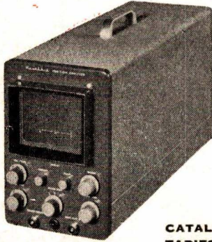
Ignoscope pour vérification d'allumage des moteurs à explosion
