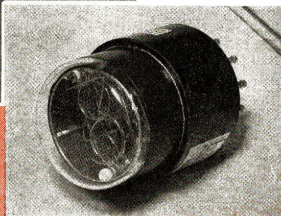
Une vieille connaissance: le tube indicateur « Nixie » (voir notre numéro 219), produit en Angleterre par St d TEL. AND CABLES.
