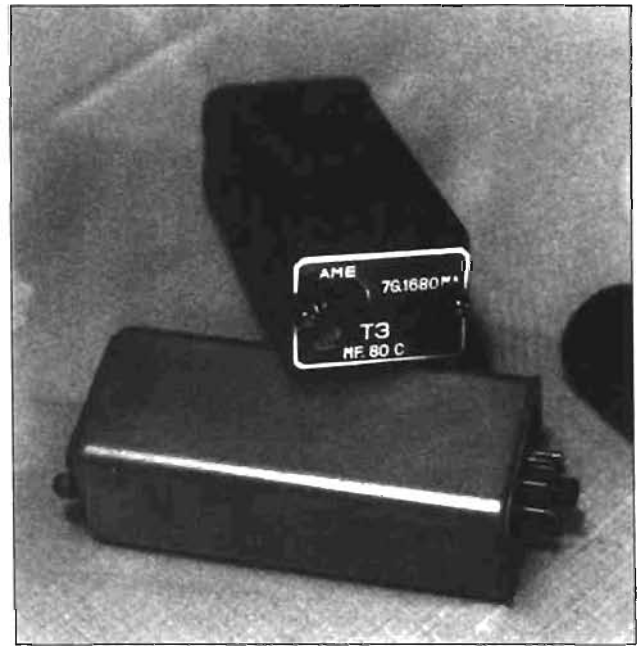
Fig. 3. — Transformateurs MF amovibles
