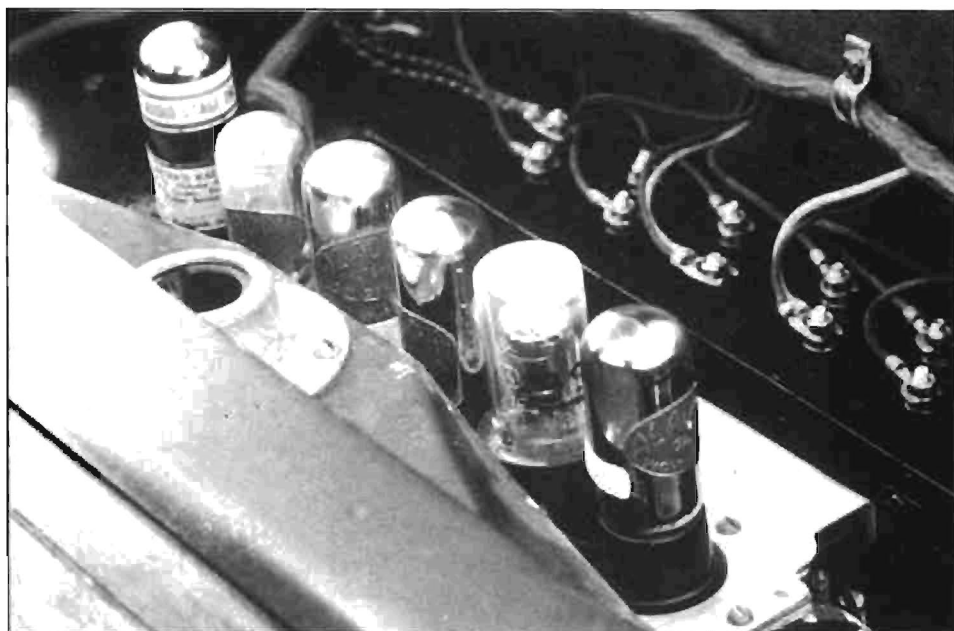
Fig. 4. — Les tubes Radiotron UX-199, à l'extrémité gauche l'UX-120
