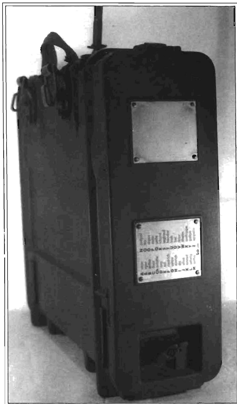
Fig. 6. — Feldfu, panneau avant fermé
