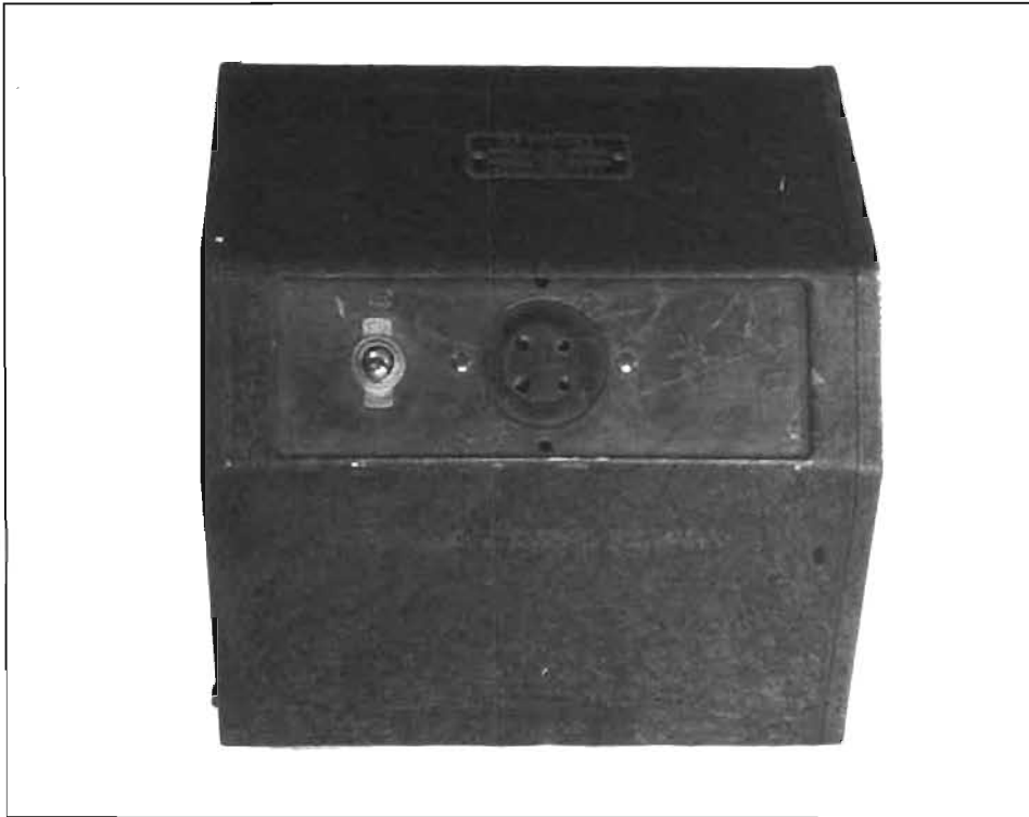
12. — L'alimentation du FB7 Il s'agit du modèle 5887 qui fournit une HT de 180 volts
