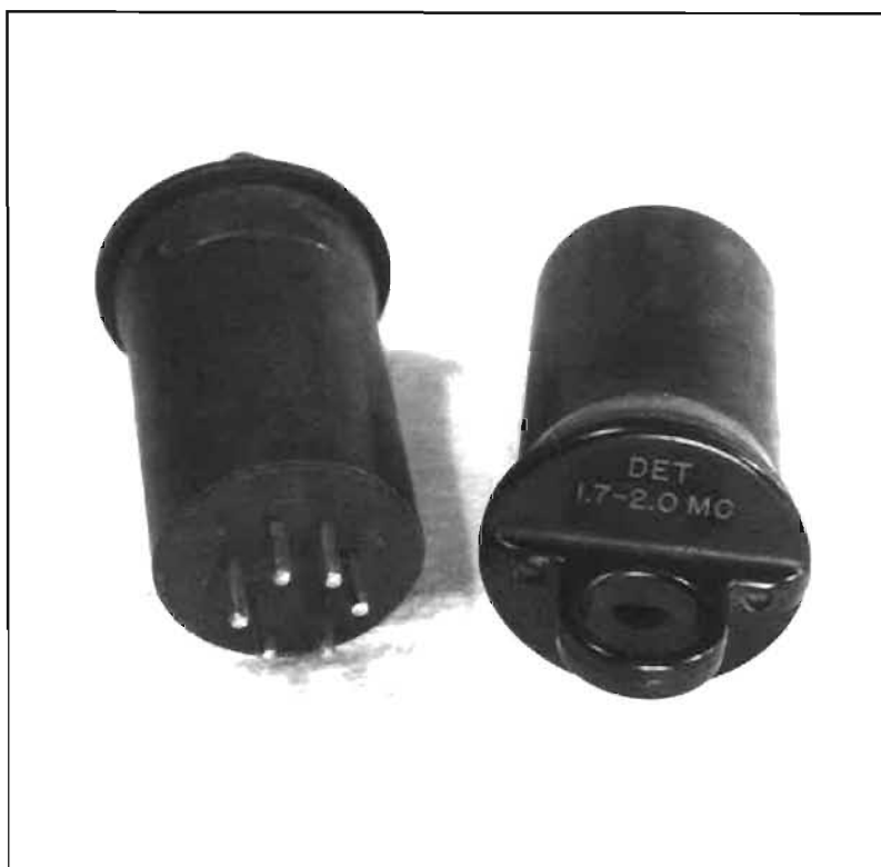
14. — Selfs interchangeables R-39 - plug-in inductors - pour récepteurs FB-7 et FB-X
