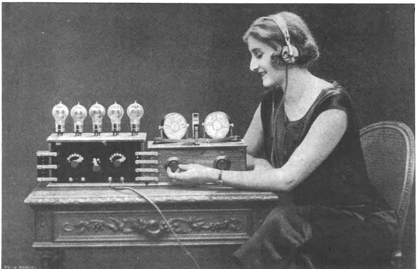
Fig. 9. et 10. — Poste 5 lampes à Coronmas
