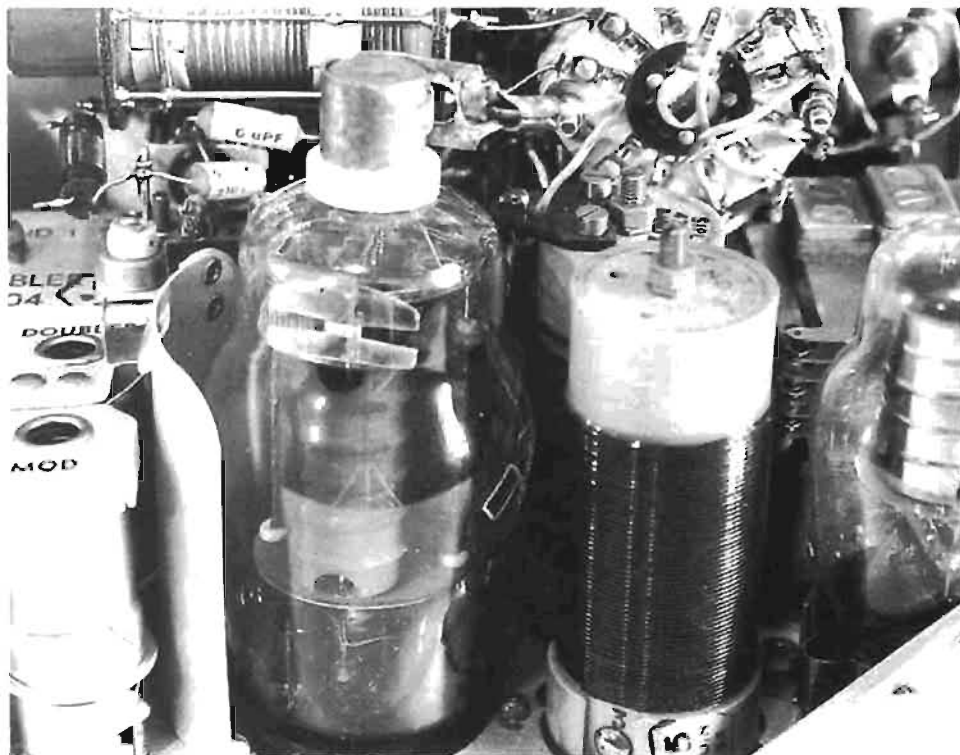
Fig. 9. — L'étage de puissance et la 2E22
